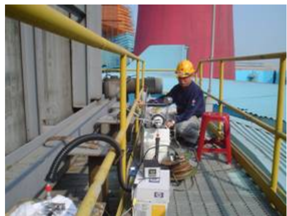
圖2、於台中電廠2號機組靜電集塵器後端位置進行煙氣中汞物種的現場採樣。
