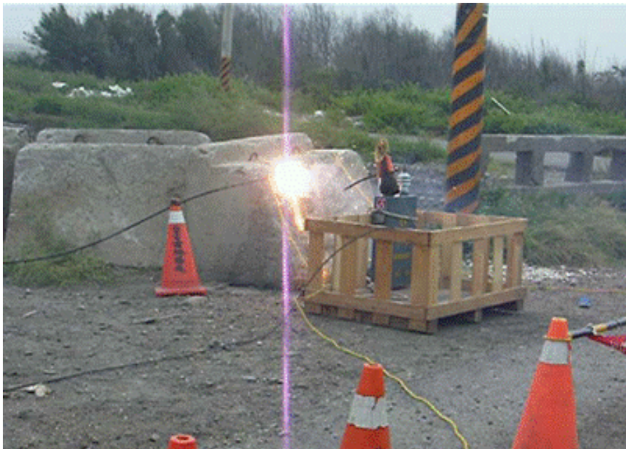
圖2、被覆線掉落於水泥塊所引起之弧光
