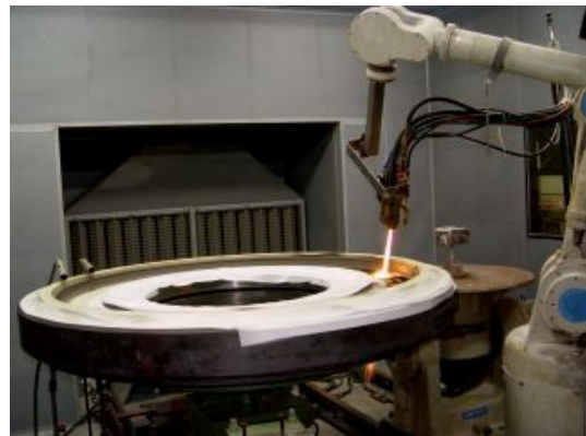
圖 2. 進行 HVOF 噴鐸抗沖蝕塗層情形
