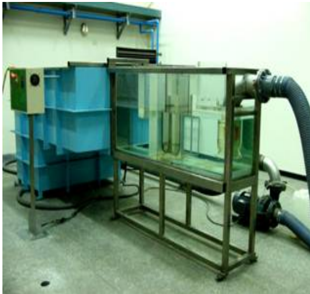
圖1、水工模型試驗布置側視圖
