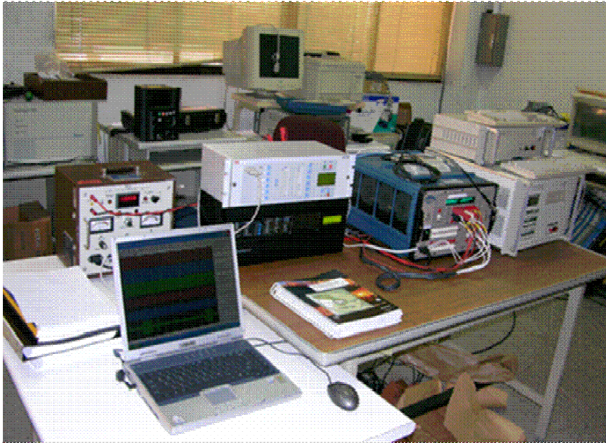
圖1、實驗室內高阻抗試驗平台實體圖
