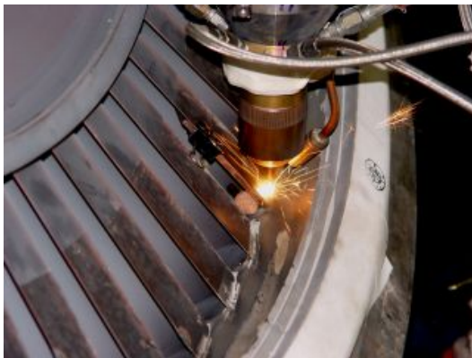
圖 1. 靜葉環進行雷射送粉鐸補情形
