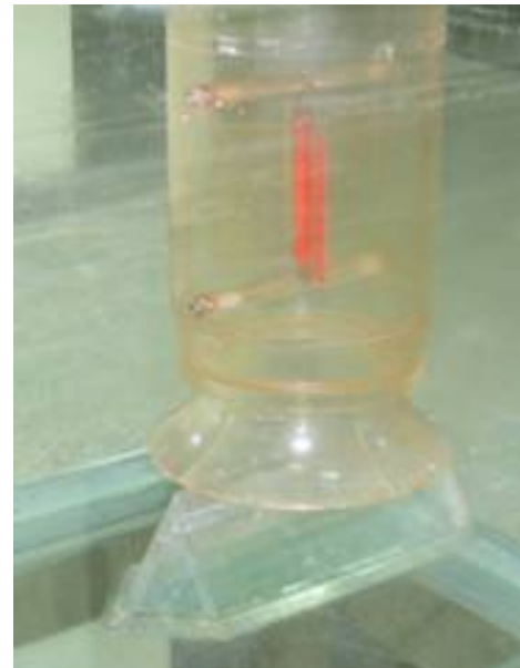
圖2、鐘型吸入口下方所加三角形分隔版
