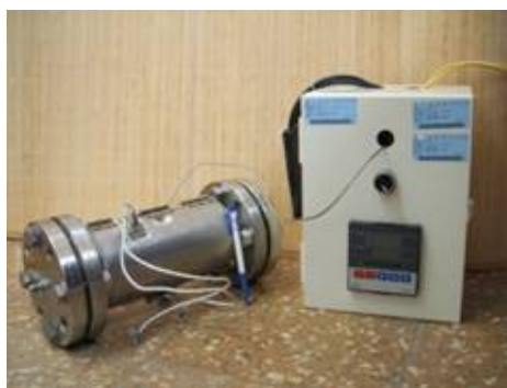
圖1、簡易型高溫儲氫反應容器供儲氫模擬
