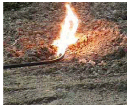
圖 2、高阻抗人工故障發生在水泥地
