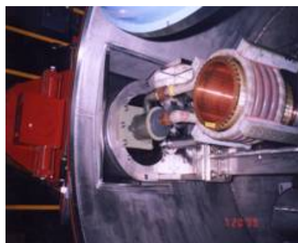
圖2、真空熔煉爐供研製新型儲氫合金
