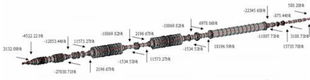
圖1、等效軸對心調整示意圖
